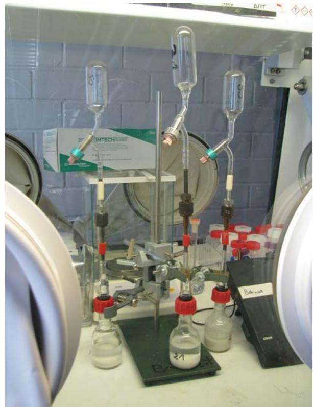
Abb. 8: Experimenteller Aufbau in einer Inertgas-Handschuhbox zur Untersuchung der CO<sub>2</sub>-Gas Gleichgewichte und zur Gewinnung von Porenwasser auch durch Äquibrierung mit dem Gestein.
