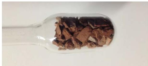
b) Probenmaterial im BET Mess-Kolben.
