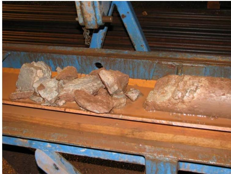
Abb. 1: Bohrkern vor der Probenahme.
