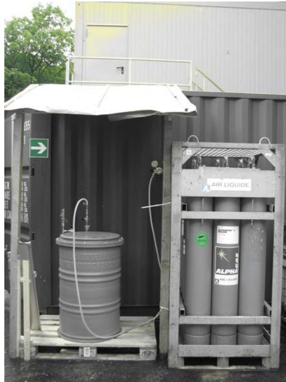
Abb. 2: Lagerbehälter für Bohrkern für Sorptionsversuche einschließlich Argon-Versorgung auf dem Bohrplatz Remlingen 15.
