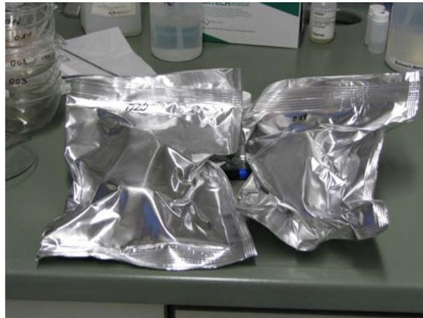
Abb. 3 Eingeschweißte und tiefgefrorene Gesteinsproben aus dem Röt (Probe 020\_KIT und 018\_KIT).
