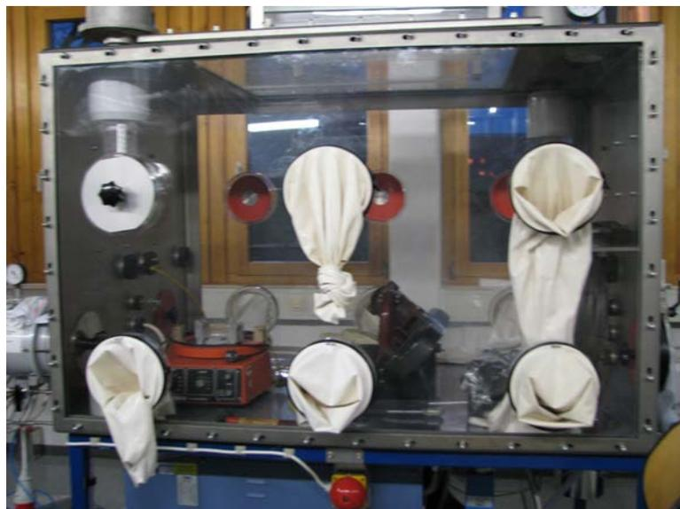
Abb. 5 Inertgasbox zur Präparation der Gesteinsproben.
